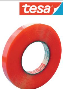
**Dati Tecnici:** Categoria: Nastro biadesivo · Caratteristiche: Resistente alla temperatura · Spessore: 0.205 mm · Colore: Trasparente · Tipi di colla: Acrilico · Materiale di supporto: Pellicola in polietilene · Contenuto: 1 Rotolo(i)
