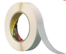
**Dati Tecnici:** Categoria: Nastro biadesivo · Caratteristiche: Autoadesivo · Per uso universale · Spessore: 0.13 mm · Colore: crema · Tipi di colla: gomma · Materiale di supporto: Tessuto non tessuto · Tipo: 3M 983XL · Contenuto: 1 Rotolo(i)
