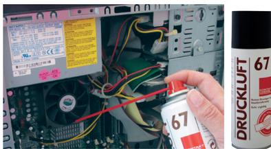
Spray gas compresso per soffiare la polvere e la sporcizia - sicura, pulita, priva di olio. Non infiammabile sotto il 2008/47 / CE. AIR 67 comprende un gas pulito, asciutto compressa
