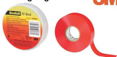
**Dati tecnici:** Spessore: 0.18 mm · Forza di strappo: 30 N/10 mm · Materiale supporto: PVC · Gamma di temperatura: fino +90 °C · tensione di perforazione: 45 kV · Tipo: SCOTCH™ 35 · Lunghezza: 20 m · Larghezza: 19 mm.
