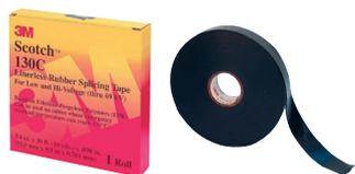
**Dati tecnici:** Categoria: Nastro per riparazioni · Caratteristiche: Autofusione · Spessore: 0.76 mm · Forza di strappo: 13 N/10 mm · Colore: Nero · Materiale di supporto: Silicone · Tipo: Caucciù al propilene-etilene Scotch™
