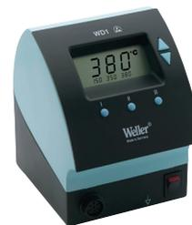
ria: Unità di alimentazione per saldatura · Tensione di esercizio: 230 V/AC · Potenza (max.): 80 W · Min. temperatura: +50 °C · Indicatore: digitale · Intervallo di temperatura: +50 fino a +450 °C
