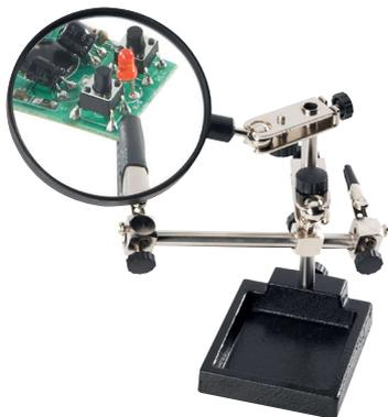
Ausilio universale regolabile per montaggio e saldatura con lente in vetro molto grande.
