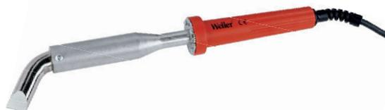
Il saldatore a mano con punta curva, è ideale per lavori di precisione. **Dati tecnici:** Temperatura max.: +520 °C · Tensione di esercizio: 230 V · Categoria: Saldatore · Tipo punte di saldatura: Forma a scalpello · Potenza (max.): 200 W · Intervallo di temperatura: +520 °C (max) **Incluso nella consegna:** Punta di saldatura curvata
