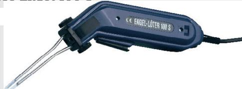
Per lavori con lega di saldatura dolce fino a 12 mm<sup>2</sup> ca. Con illuminazione. **Dati tecnici:** Tensione di esercizio: 230 V · Categoria: Saldatore a pistola · Tipo punte di saldatura: Punta per saldatura continua · Potenza (max.): 80 W
